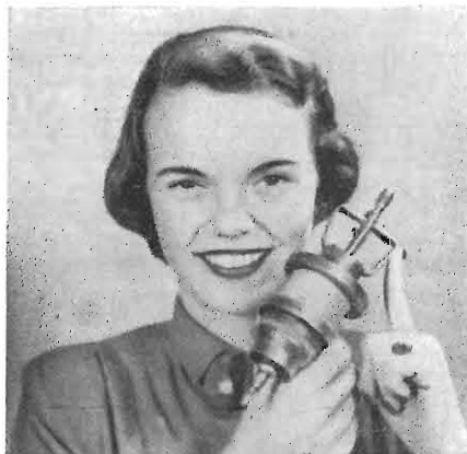
Nuovo tipo di valvola trasmittente ceramica costruita dalla General Electric Co. che permette di ottenere una potenza d'uscita di 1 kW sino a 900 MHz. Si tratta del tipo GL-6019, espressamente progettato per trasmettitori di televisione per altissime frequenze.
